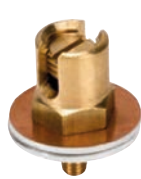
Borne BFR CLIP Kit de borne + 2 rondelles bimétales M6 pour une mise à la terre - Diam. câbles 4 à 6mm 2 16-25mm 2
