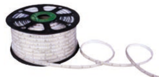
RUBAN 50m 230V 9W/M 6500K IP65 (non sécable) AVEC FICHE 2P+T, IP44, 700lm/m.
