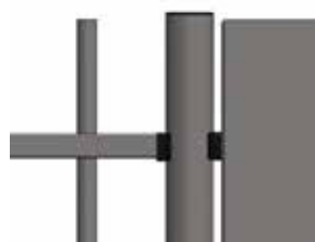
Liaison invisible et visserie inaccessible après montage
